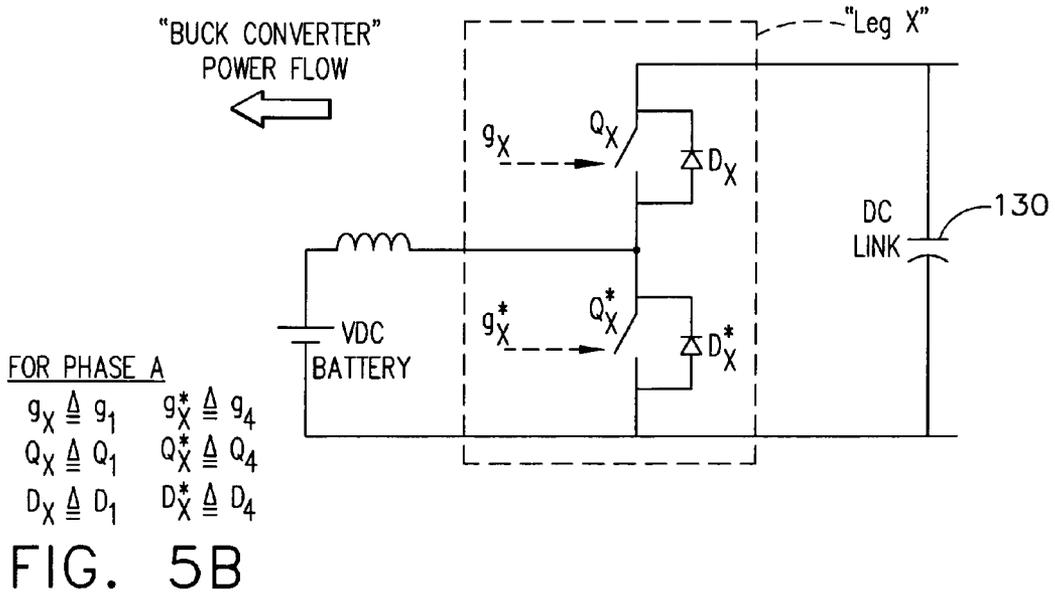
**ELECTRICAL POWER SYSTEM FOR MULTI-USE POWER CONDITIONING AND ENGINE START**
