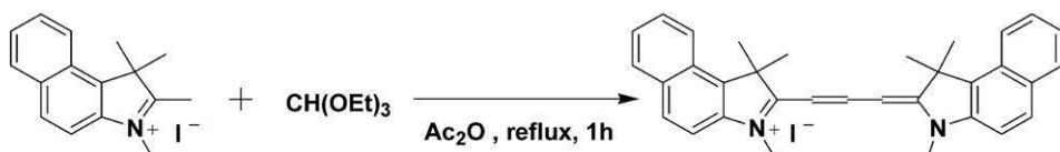
温度計、滴下ろと、冷却管、窒素フロー管を具備した100mL4口フラスコに1,2,3,3-テトラメチル-4,5-ベンゾ-3H-インドールヨージド5g、無水酢酸15mL加え、加熱還流させた。そこへ滴下ろとを用いてオルトギ酸トリエチル2.10g滴下した。1時間後、室温まで冷却し、固体を析出させた。析出した固体を吸引ろかし、酢酸エチル30mL、イオン交換水30mLで洗浄した。熱風乾燥機にて40で1晩加熱乾燥し、3.41gの生成物を得た。収率は82%であった。質量分析装置(TOF-MS:ブルカー・ダルトン社製autoflex II)で化合物の同定を行なった。 $m/z = 584.33$ (分子量584.17)で目的物であることを確認した。
