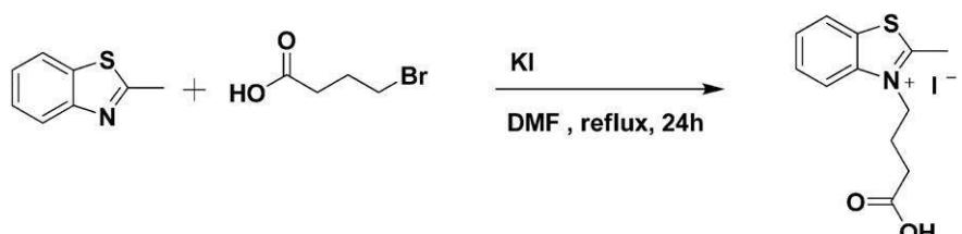
温度計、滴下ろうと、冷却管を具備した100 mL4口フラスコに2-メチルベンゾチアゾール 5 g、4-ブロモ酪酸 11.19 g、ヨウ化カリウム 11.05 g、アセトニトリル 30 mLを加え、24時間加熱還流した。室温まで冷却後、エバポレーターにて溶媒を留去し、固体を析出させた。そこへジエチルエーテル40 mL加え、洗浄し吸引ろ過した。10.22 gの生成物を得た。収率は84%であった。質量分析装置( TOF - MS : ブルカー・ダルトニクス社製 autoflex II )で化合物の同定を行なった。m/z = 363.09 (分子量 362.98) で目的物であることを確認した。
