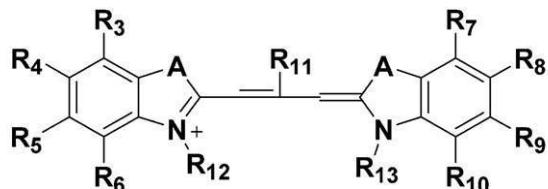
[一般式(2)中、Aは置換もしくは水素原子を有する炭素原子、または硫黄原子を表す。R<sub>3</sub>～R<sub>10</sub>はそれぞれ独立に、水素原子、ハロゲン原子、ニトロ基、置換もしくは無置換の炭素数1～4のアルキル基、置換もしくは無置換の炭素数1～4のアルコキシ基、置換もしくは無置換のアリール基、または置換もしくは無置換のアシル基を表す。R<sub>11</sub>は、水素原子、置換もしくは無置換の炭素数1～4のアルキル基、またはハロゲン原子を表す。R<sub>12</sub>およびR<sub>13</sub>は、それぞれ独立に水素原子、または置換もしくは無置換の炭素数1～6のアルキル基、または重合性官能基を有する有機基を表す。]40
