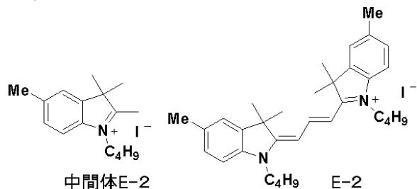
中間体 E - 1 のヨードエタンをヨードブタンに変更した以外は、中間体 E - 1 と同様に合成し、9.07 g の生成物 (中間体 E - 2) を得た。収率は 88 % であった。質量分析装置 (TOF - MS : ブルカー・ダルトニクス社製 autoflex II) で化合物の同定を行なった。カチオン成分  $m/z = 230.31$  (分子量 230.19) で目的物であることを確認した。中間体 E - 2 を用いた以外は、A - 1 と同様に合成し、6.44 g の生成物 (E - 2) を得た。収率は 85 % であった。質量分析装置 (TOF - MS : ブルカー・ダルトニクス社製 autoflex II) で化合物の同定を行なった。カチオン成分  $m/z = 469.46$  (分子量 469.36) で目的物であることを確認した。
