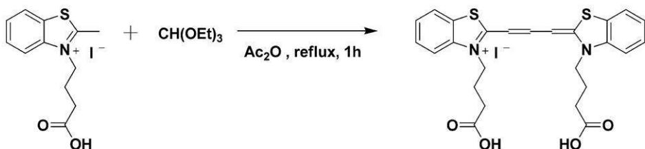
温度計、滴下ろうと、冷却管、窒素フロー管を具備した100 mL4口フラスコに3-酪酸-2-メチルベンゾチアゾリウムヨージド 5 g、無水酢酸 15 mL加え、加熱還流させた。そこへ滴下ろうとを用いてオルトギ酸トリエチル 2.04 g滴下した。1時間後、室温まで冷却し、固体を析出させた。析出した固体を吸引ろかし、酢酸エチル 30 mL、イオン交換水 30 mLで洗浄した。熱風乾燥機にて40 °Cで1晩加熱乾燥し、2.72 gの生成物を得た。収率は65%であった。質量分析装置(TOF-MS:ブルカー・ダルトニクス社製 autoflex II)で化合物の同定を行なった。m/z = 642.29 (分子量 642.20)で目的物であることを確認した。
