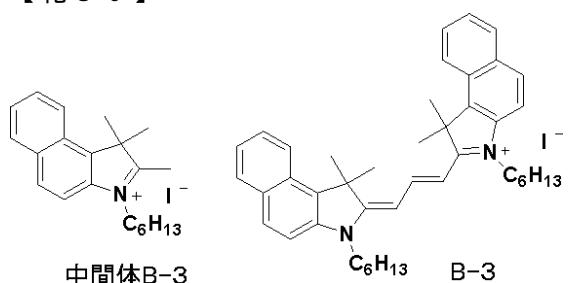
中間体B-1のヨードエタンをヨードヘキサンに変更した以外は、中間体B-1と同様に合成し、8.56gの生成物（中間体B-3）を得た。収率は85%であった。質量分析装置（TOF-MS：ブルカー・ダルトニクス社製 autoflex II）で化合物の同定を行なった。カチオン成分 $m/z = 294.32$ （分子量294.22）で目的物であることを確認した。中間体B-3を用いた以外は、A-1と同様に合成し、6.48gの生成物（B-3）を得た。収率は88%であった。質量分析装置（TOF-MS：ブルカー・ダルトニクス社製 autoflex II）で化合物の同定を行なった。カチオン成分 $m/z = 597.55$ （分子量597.42）で目的物であることを確認した。
