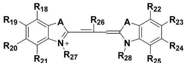
[一般式(4)中、Aは置換基もしくは水素原子を有する炭素原子、または硫黄原子を表す。R<sub>18</sub>～R<sub>25</sub>はそれぞれ独立に、水素原子、ハロゲン原子、ニトロ基、置換もしくは無置換の炭素数1～4のアルキル基、置換もしくは無置換の炭素数1～4のアルコキシ基、置換もしくは無置換のアリール基、または置換もしくは無置換のアシル基を表す。R<sub>26</sub>は、水素原子、置換もしくは無置換の炭素数1～4のアルキル基、またはハロゲン原子を表す。R<sub>27</sub>およびR<sub>28</sub>は、それぞれ独立に、末端にカルボキシル基もしくはスルホ基であるアニオン性置換基を有する置換もしくは無置換のアルキル基である。]
