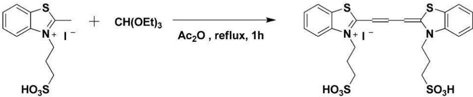
温度計、滴下ろうと、冷却管、窒素フロー管を具備した100 mL4口フラスコに3-プロパンスルホン酸-2-メチルベンゾチアゾリウムヨージド 5 g、無水酢酸 15 mL加え、加熱還流させた。そこへ滴下ろうとを用いてオルトギ酸トリエチル 1.85 g滴下した。1時間後、室温まで冷却し、固体を析出させた。析出した固体を吸引ろかし、酢酸エチ
