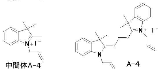
中間体A-1のヨードエタンを3-ヨードプロピレンに変更した以外は、中間体A-1と同様に合成し、9.04 gの生成物（中間体A-4）を得た。収率は88%であった。<sup>30</sup> 質量分析装置（TOF-MS：ブルカー・ダルトニクス社製 autoflex II）で化合物の同定を行なった。カチオン成分m/z = 200.28（分子量200.14）で目的物であることを確認した。中間体A-4を用い、反応温度を80℃に変更した以外は、A-1と同様に合成した。4.60 gの生成物（A-4）を得た。収率は62%であった。質量分析装置（TOF-MS：ブルカー・ダルトニクス社製 autoflex II）で化合物の同定を行なった。カチオン成分m/z = 409.36（分子量409.26）で目的物であることを確認した。
