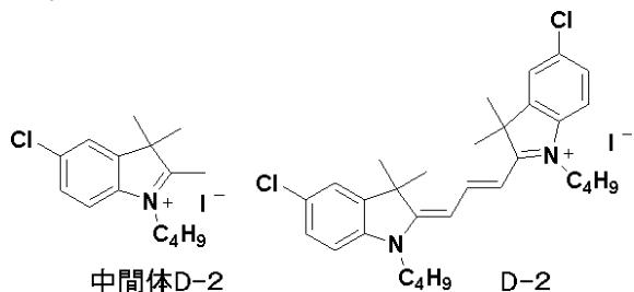
中間体D-1のヨードエタンをヨードブタンに変更した以外は、中間体D-1と同様に合成し、8.58 gの生成物（中間体D-2）を得た。収率は88%であった。質量分析装置（TOF-MS：ブルカー・ダルトニクス社製 autoflex II）で化合物の同定を行なった。カチオン成分 $m/z = 250.28$ （分子量250.14）で目的物であることを確認した。中間体D-2を用いた以外は、A-1と同様に合成し、6.44 gの生成物（D-2）を得た。収率は89%であった。質量分析装置（TOF-MS：ブルカー・ダルトニクス社製 autoflex II）で化合物の同定を行なった。カチオン成分 $m/z = 509.38$ （分子量509.25）で目的物であることを確認した。
