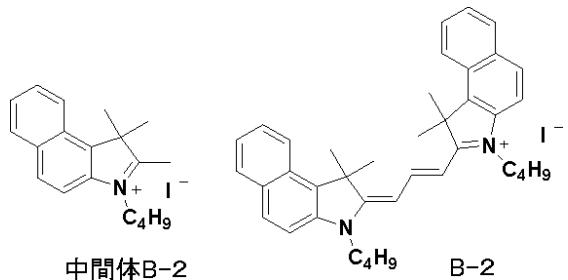
中間体B-1のヨードエタンをヨードブタンに変更した以外は、中間体B-1と同様に合成し、8.27gの生成物（中間体B-2）を得た。収率は88%であった。質量分析装置（TOF-MS：ブルカー・ダルトニクス社製 autoflex II）で化合物の同定を行なった。カチオン成分 $m/z = 266.30$ （分子量266.19）で目的物であることを確認した。中間体B-2を用いた以外は、A-1と同様に合成し、6.33gの生成物（B-2）を得た。収率は90%であった。質量分析装置（TOF-MS：ブルカー・ダルトニクス社製 autoflex II）で化合物の同定を行なった。カチオン成分 $m/z = 541.48$ （分子量541.36）で目的物であることを確認した。
