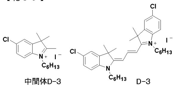
中間体D-1のヨードエタンをヨードヘキサンに変更した以外は、中間体D-1と同様に合成し、9.11 gの生成物（中間体D-3）を得た。収率は87%であった。質量分析装置（TOF-MS：ブルカー・ダルトニクス社製 autoflex II）で化合物の同定を行なった。カチオン成分 $m/z = 278.27$ （分子量278.17）で目的物であることを確認した。中間体D-3を用いた以外は、A-1と同様に合成し、6.85 gの生成物（D-3）を得た。収率は88%であった。質量分析装置（TOF-MS：ブルカー・ダルトニクス社製 autoflex II）で化合物の同定を行なった。カチオン成分 $m/z = 565.44$ （分子量565.31）で目的物であることを確認した。
