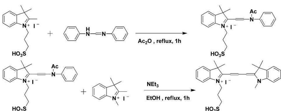
温度計、滴下ろうと、冷却管、窒素フロー管を具備した 100 mL4 口フラスコに 1-プロパンスルホン酸-2,3,3-テトラメチルインドレニンヨージド 5 g、無水酢酸 15 mL 加え、加熱還流させた。そこへ滴下ろうとを用いて N,N'-ジフェニルホルムアミジン 2.39 g 滴下した。1 時間後、室温まで冷却し、ジエチルエーテル 30 mL 加え 30 分攪拌し、固体を析出させた。析出した固体を吸引ろかし、ジエチルエーテル 30 mL、イオン交換水 30 mL で洗浄した。熱風乾燥機にて 40 度 1 晚加熱乾燥し、3.59 g の生成物を得た。この生成物を温度計、滴下ろうと、冷却管、窒素フロー管を具備した 100 mL4 口フラスコに加えた。そこへさらにエタノール 30 mL、トリエチルアミン 0.5 mL、
