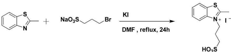
温度計、滴下ろうと、冷却管を具備した100 mL4口フラスコに2-メチルベンゾチアゾール 5 g、3-プロモプロパンスルホン酸ナトリウム 15.08 g、ヨウ化カリウム 11.05 g、アセトニトリル 30 mLを加え、24時間加熱還流した。室温まで冷却後、エバポレーターにて溶媒を留去し、固体を析出させた。そこへジエチルエーテル 40 mL加え、洗浄し吸引ろ過した。10.43 gの生成物を得た。収率は78%であった。質量分析装置(TOF-MS:ブルカー・ダルトニクス社製 autoflex II)で化合物の同定を行なった。m/z = 399.12 (分子量 398.95)で目的物であることを確認した。
