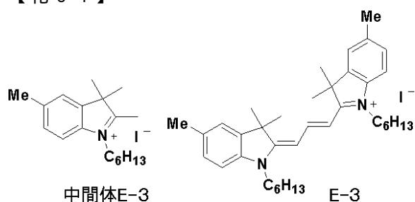
中間体 E - 1 のヨードエタンをヨードヘキサンに変更した以外は、中間体 E - 1 と同様に合成し、9.34 g の生成物 (中間体 E - 3) を得た。収率は 84 % であった。質量分析装置 (TOF - MS : ブルカー・ダルトニクス社製 autoflex II) で化合物の同定を行なった。カチオン成分  $m/z = 258.35$  (分子量 258.22) で目的物であることを確認した。中間体 E - 3 を用いた以外は、A - 1 と同様に合成した。6.25 g の生成物 (E - 3) を得た。収率は 79 % であった。質量分析装置 (TOF - MS : ブルカー・ダルトニクス社製 autoflex II) で化合物の同定を行なった。カチオン成分  $m/z = 525.53$  (分子量 525.42) で目的物であることを確認した。
