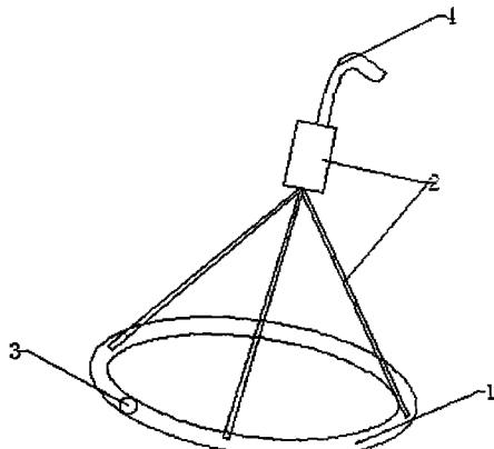
1. 用于固定电吹风的装置,其特征在于:包括圆环(1)、与所述圆环(1)连接的悬挂装置(2),所述圆环(1)上设有放置电吹风的安装装置(3),在所述悬挂装置(2)上设有用于周向驱动悬挂装置(2)转动的电机。
