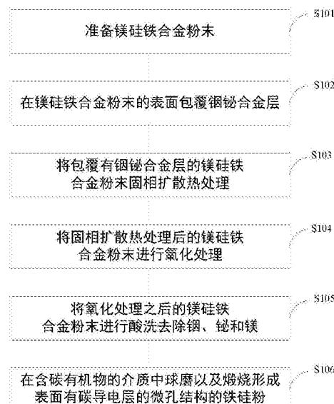
1. 一种钢铋合金包覆镁硅铁颗粒制备泡沫状硅铁粉的方法,包括:
