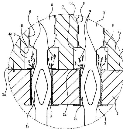
1. 一种板载连接器，其适于安装在电路板的上下表面中的一个表面上，从而所述板载连接器电连接到从所述电路板的上表面延伸到下表面的通孔焊盘上，所述板载连接器包括：
