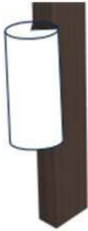
〈기둥 및 벽체 적용 종이완충커버 적용 예시 모식도〉
