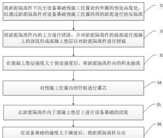
1. 一种滩涂回填区域淤泥地质条件下设备基础的施工方法,其特征在于,包括如下步骤:
