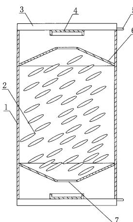
1、便捷取药急救药瓶，包括瓶体和瓶盖，其特征在于瓶体为圆筒形，瓶体的两端都设置有瓶盖，瓶盖与瓶体卡接在一起，瓶体内两端都设置有锥形导药槽，锥形导药槽的顶端设置有出药口，药片放置在两锥形导药槽之间构成的空腔中，瓶盖的内侧中心部位设置有药片槽，药片槽与出药口正面对应。
