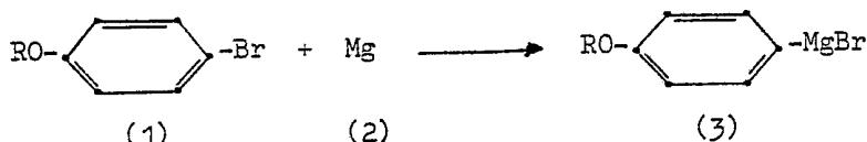
Cette réaction s'effectue dans les solvants généralement mis en oeuvre pour la préparation des organo-magnésiens, ou dans des mélanges de tels solvants, par exemple les éthers-oxydes, en particulier l'éther diéthylique et le tétrahydrofurane.
