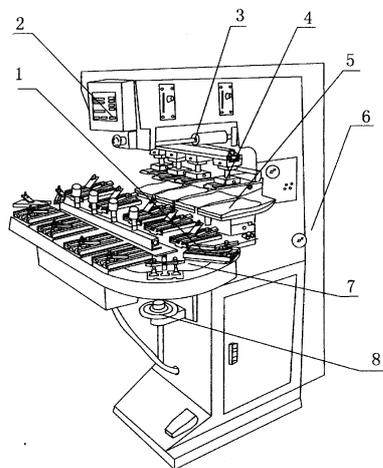
1、一种全电脑触摸程控移印机，包括机体、印头组件、工作台组件、使印头组件及工作台组件动作的传动装置及触摸显示屏，其特征在于，所述工作台组件具有固定工件的夹具及使夹具转动的转盘，所述转盘与传动装置传动连接；所述印头组件包括印头、供印头移动的导轨以及与印头配合使用的油墨盘，所述印头配装有气缸；所述触摸显示屏包括有可编程控制器及液晶显示屏，所述可编程控制器分别与印头组件及工作台组件的传动装置联结。
