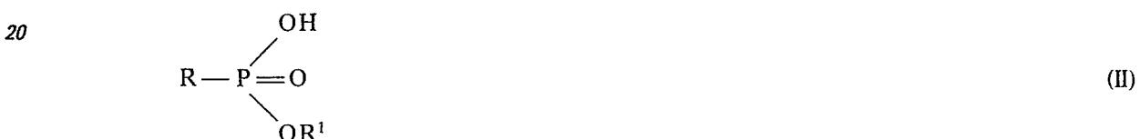
25 in der R einen linearen Alkylrest mit 6 bis 24, vorzugsweise 8 bis 18 Kohlenstoffatomen und R<sup>1</sup> einen Alkylrest mit 1 bis 8, vorzugsweise 1 bis 4 Kohlenstoffatomen bedeuten, oder ein Gemisch eines solchen Salzes mit einer Alkanphosphonsäure der Formel (I)
