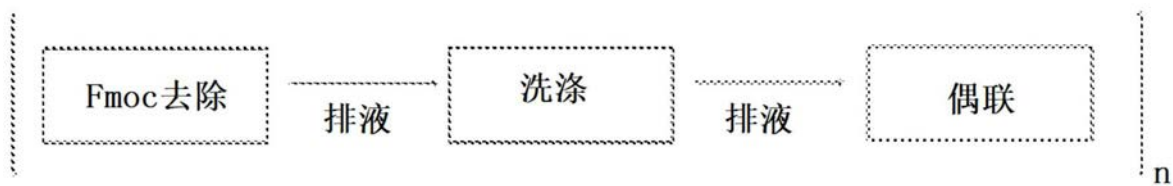
用于固相肽合成的原位溶剂再循环方法
