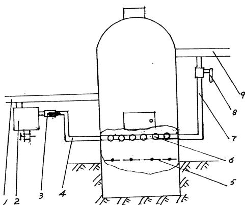
1、水管炉排常压锅炉，由炉排、燃燃室、换热面、进水管、出水管组成，其特征是：炉排由水管连接制成，这种水管炉排(6)的进水管(4)连接锅炉的进水管(1)，其出水管(7)连接锅炉的出水管(9)，水管炉排的进水管和出水管上分别装有阀门(3)和(8)；炉排下面的储灰室内有活动翻板(5)。
