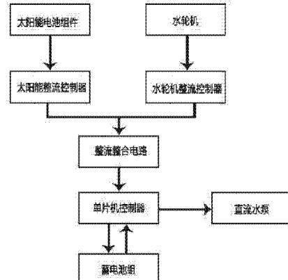
1. 一种可在扬水过程中补充充电的光伏水泵，包括太阳能电池组件、太阳能整流控制器、直流水泵、蓄电池组、蓄水池、单片机控制器、水轮机、水轮机整流控制器、整流整合电路，其特征在于太阳能电池组件连接太阳能整流控制器构成光伏发电系统，水轮机连接水轮机整流控制器构成水力发电系统，光伏发电系统、水力发电系统分别通过整流整合电路连接单片机控制器和蓄电池组。
