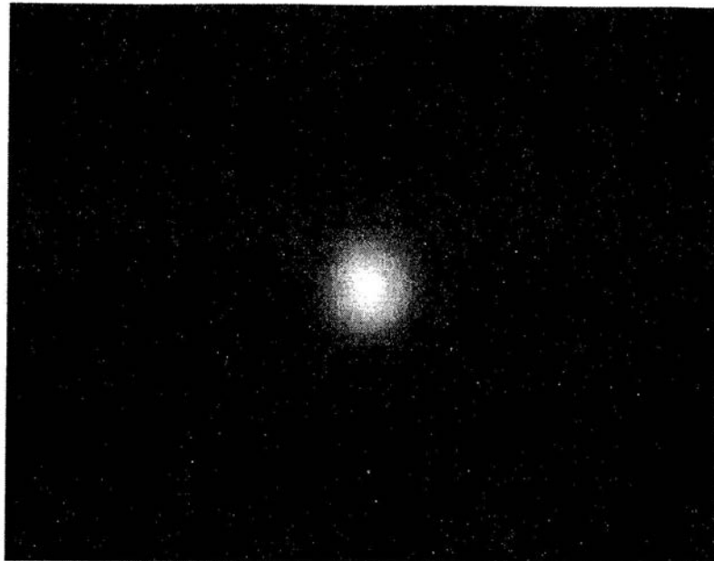
LEDのPSF (黒い囲みはLEDのグリッドを示している)
