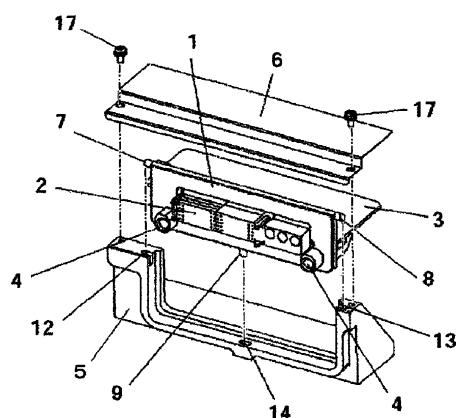
1. 一种连接器装置，是具有浮动结构的背插式连接器装置，其特征在于，包括主体底座、盖、以及搭载有连接器的支撑板，
