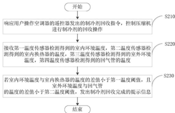
1. 一种空调器自动回收制冷剂的控制方法,其特征在于,所述空调器包括室内机和室外机,所述室内机内安装有室内换热器,所述室内机设置有裸露于室内环境中的第一温度传感器,所述室内换热器处设置有第二温度传感器,所述室外机内安装有压缩机,所述压缩机通过回气管与所述室内换热器连接,所述室外机设置有裸露于室外环境的第三温度传感器,所述回气管处设置有第四温度传感器,所述第一温度传感器、第二温度传感器、第三温度传感器以及第四温度传感器均与设置于所述空调器内的控制器连接,所述方法应用于控制器,所述方法包括:
