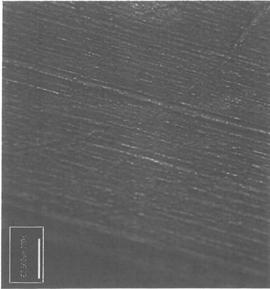
SUS-HCl(35%、25ml) 45℃、20分エッチングした表面
