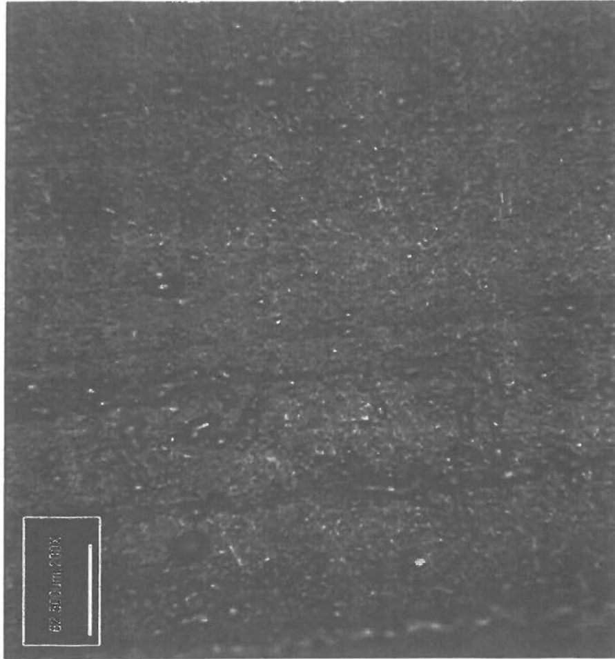
NiTi-FeCl 3 水溶液で40℃、1分間エッチングした表面
