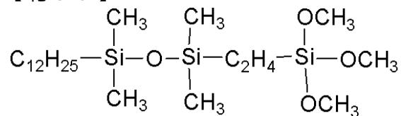
で表されるシリアルキレンオリゴシロキサン5重量部を投入し、予備混合した後、真空下、150℃で加熱攪拌した後、室温まで冷却して、in-situで表面処理されたアルミナ粉末を含有するシリコーンゴムベースを調製した。
