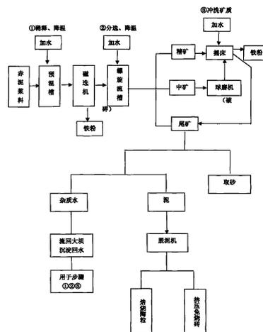
1、 氧化铝赤泥选铁工艺，其特征在于包括下述工艺步骤：赤泥浆料加水预混，进行稀释和降温，再进入螺旋流槽进行分选，分选出精矿浆料、中矿浆料和尾矿浆料；精矿浆料进入摇床，加水分流，摇床侧部分流出矿质浆料，端部分流出铁粉浆料，铁粉浆料进入产品槽；所述中矿浆料填入球磨机进行球磨破碎后，进入所述摇床随精矿浆料一起进行分流。
