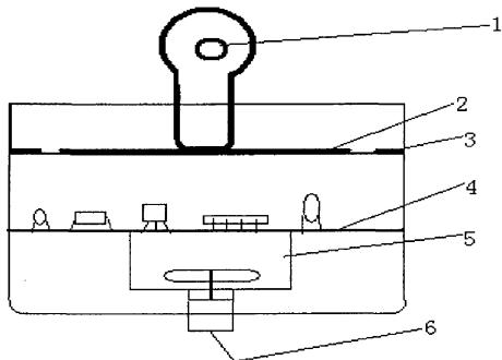
1、配电网电子式电压互感器及其测量相电压的方法，是由：高压接触臂（1），电场拾取板极（2），电场拾取板的均压环（3），处理电路（4），光纤传输模块（5），数据光口（6）构成；其特征在于：壳体内底面的中部设置有数据光口（6），数据光口（6）的上方及壳体的中下方设置有光纤传输模块（5），光纤传输模块（5）的上方设置有处理电路（4），处理电路（4）的上方设置有电场拾取板，电场拾取板面的一侧设置有电场拾取板极（2），电场拾取板的均压环（3）设置在电场拾取板极（2）的外围，高压接触臂（1）垂直设置在电场拾取板的中间。
