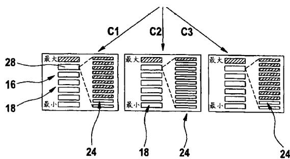
1. 用于探测在介质 (12) 中被包围的物体 (14) 的探测仪, 具有一个用于再现至少一个与至少一个传感器的测量信号相关的输出参数的输出单元 (16), 其中, 该输出单元 (16) 具有一个用于再现与该测量信号相关的输出参数的第一动态区 (30), 其特征在于, 通过该输出单元 (16) 可再现至少一个第二动态区 (26), 该至少一个第二动态区 (26) 相对于第一动态区 (30) 提高了灵敏度, 其中, 所述至少一个第二动态区 (26) 的最小和最大界限取决于测量参数的实际存在的信号强度。
