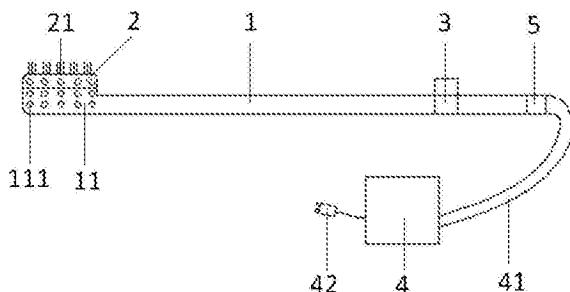
1. 一种牙刷，其特征在于，包括：刷柄、刷毛和用于给牙刷供气的气泵，所述刷柄的一端设置有刷头，所述刷毛设置在刷毛座上，所述刷毛座设置在所述刷头的上方且所述刷毛座和所述刷头构成牙刷本体，所述牙刷本体上设置有用于气流通过的气孔；
