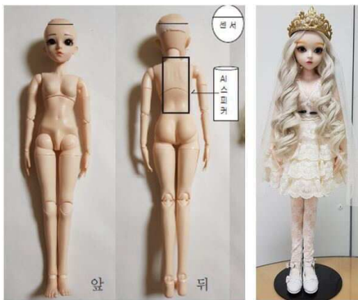
조립 - 머리센서내장, 몸통-인공지능스피커 내장 완성 - 가발, 메이크업, 패션 완성제품(다양한 캐릭터로 변신 가능함)
