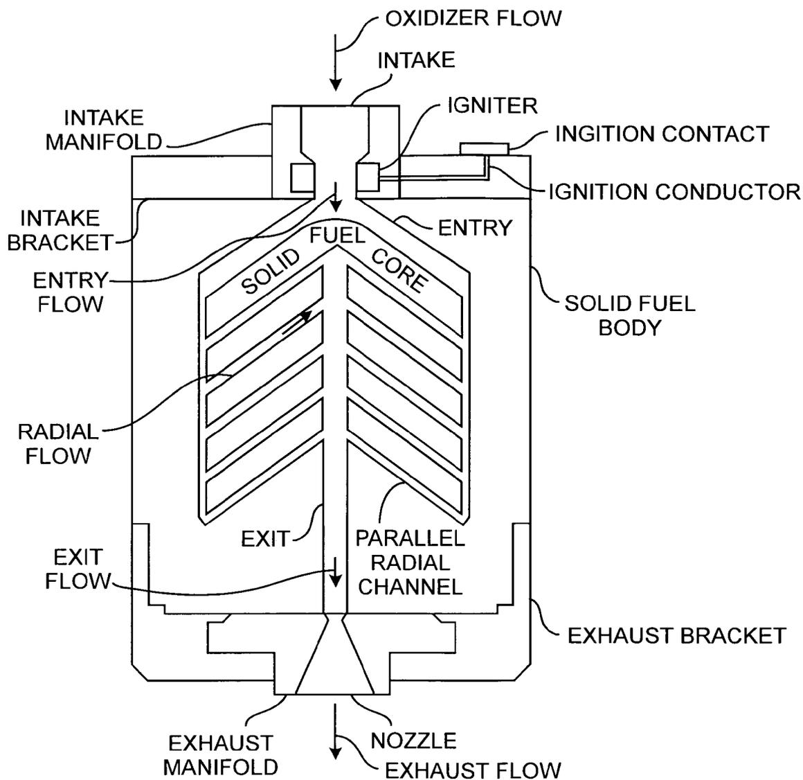
PARALLEL RADIAL CHANNEL SOLID FUEL STEREOGRAPHIC ROCKET MOTOR
