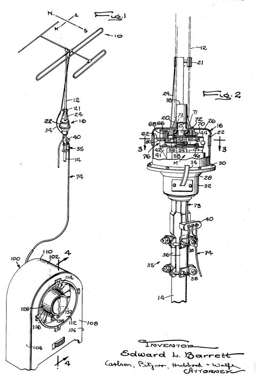
DIRECTIONAL CONTROL MECHANISM FOR ANTENNAS
