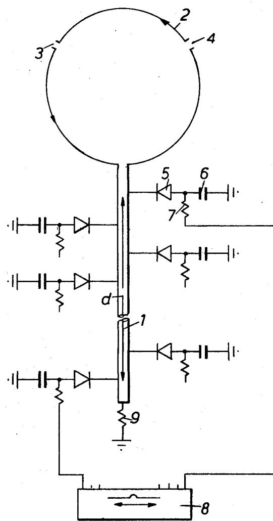
**SINGLE SIDEBAND GENERATOR EMPLOYING A PLURALITY OF CYCLICALLY SWITCHED SHORTING DIODES CONTROLLING A TRANSMISSION LINE ELECTRICAL LENGTH**
