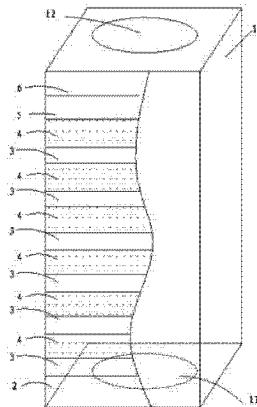
1. 一种空气净化器，其特征在于：包括壳体，壳体具有进风口和出风口，壳体内从进风口至出风口设置有第一负离子发射器、集尘器和离子发射器组、去离子器以及第二负离子发射器，其中，所述第二负离子发射器设在所述出风口的前端，所述去离子器设在第二负离子发射器的前端。
