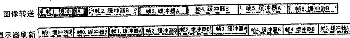
两个缓冲器，显示器刷新比图像转送快得多
