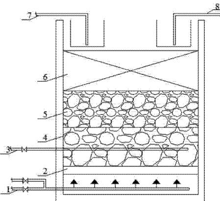
1. 一种上向流曝气生物滤池—水平潜流人工湿地组合中水处理系统,其特征在于:该系统由上向流曝气生物滤池和水平潜流人工湿地组成;
