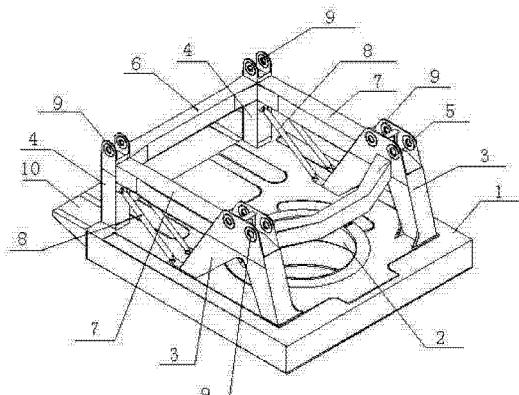
1. 一种大型绕桩式海上平台起重机回转平台,包括本体(1),其特征在于:所述本体(1)的中心开有过桩孔(2),所述本体(1)的前部两个角上表面均焊接有前支座(3),所述本体(1)的后部两个角上表面均焊接有后支座(4),两个所述前支座(3)之间通过前横梁(5)相连,两个所述后支座(4)之间通过后横梁(6)相连,所述前支座(3)与所述后支座(4)之间通过侧横梁(7)相连,每个所述侧横梁(7)的下部均设有斜撑杆(8),两个所述前支座(3)和两个所述后支座(4)上均设有用于安装吊臂和人字架的轴座(9),所述本体(1)的后部焊接有变幅绞车安装平台(10),所述本体(1)的下部焊接有圆筒体(11),所述圆筒体(11)的下部焊接有回转机构安装法兰(12),所述圆筒体(11)与所述过桩孔(2)相对应,所述圆筒体(11)的外圆周面上均匀分布有多根T型纵向加强筋(13),每个所述前支座(3)均为倒“V”型结构。
