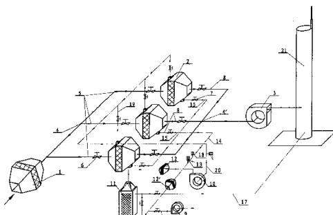
1、一种有机废气净化处理设备，主要由吸附和脱附—催化燃烧两大部分组成，其特征是：吸附部分是由滤尘器、三台或三台以上并联的吸附床、主风机、分流器组成，其中滤尘器的出气口通过分流器与并排排列的三台或三台以上吸附床的吸附进气管连接，在吸附进气管上设有阀，各吸附床的吸附出气管通过分流器与主风机连接，在吸附出气管上设有阀；脱附—催化燃烧部分是由补冷风机、三台或三台以上并联的吸附床、脱附风机、催化燃烧床组成，其中催化燃烧床的出气口通过带有阀的脱附主进气管与每台吸附床上的带有阀的脱附进气支管连接，脱附主进气管上分别连接有通向补冷风机和烟囱的支管，支管上设有阀，吸附床的脱附出气支管通过脱附主出气管与脱附风机的进气口连接，脱附风机的出气口与催化燃烧床的进气口通过管道连接。
