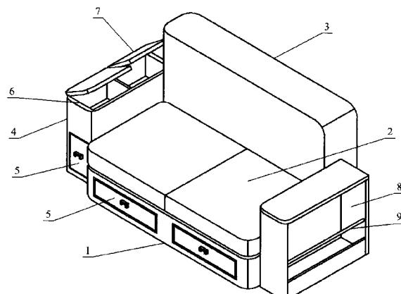
1. 一种具有储物功能的沙发,包括底座(1)、坐垫(2)、靠背(3)和扶手(4),其特征在于一侧扶手(4)的下部设有一向前抽拉的抽屉(5),上部设有开口向上的两个储物槽(6),每个储物槽(6)上各设有一个可向扶手(4)外侧掀起的盖板(7),盖板(7)与扶手(4)通过合页连接,另一侧扶手(4)设有一开口在外侧面的书刊放置槽(8);底座(1)内还设有一个或多个向前抽拉的抽屉(5)。
