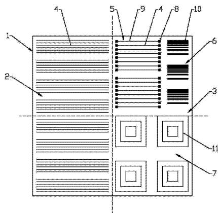
1. 一种用于晶硅太阳能电池银浆印刷实验的网版,包括网版本体(1),其特征在于所述的网版本体(1)上设有副栅线区(2)和电极区(3),副栅线区(2)由多组宽度不同的副栅线(4)组成且副栅线区(2)位于电极区(3)的一侧。
