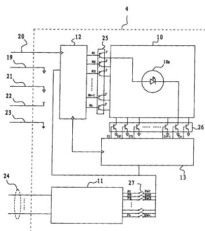
1. 一种红外线发射或接收电路板单元，包括阵列设置的红外线发射或接收管（10），其特征在于：该电路板单元上设有贯通整个电路板单元的电源线（22）、接地线（23）、时钟信号线（20）以及红外线接收信号线（19），电路板单元的一端设置具有启用控制输入端口的译码器（11）及由译码器（11）控制选通的行驱动器（12）和列驱动器（13），其中行驱动器的信号输入端口连接时钟信号线（20），行驱动器的信号输出端口连接列驱动器（13）的信号输入端口；与阵列中的每个红外线发射或接收管（10）连接的列驱动线分别通过列控制三极管（26）与列驱动器（13）连接，行驱动线分别与行驱动器（12）的行控制线连接。
