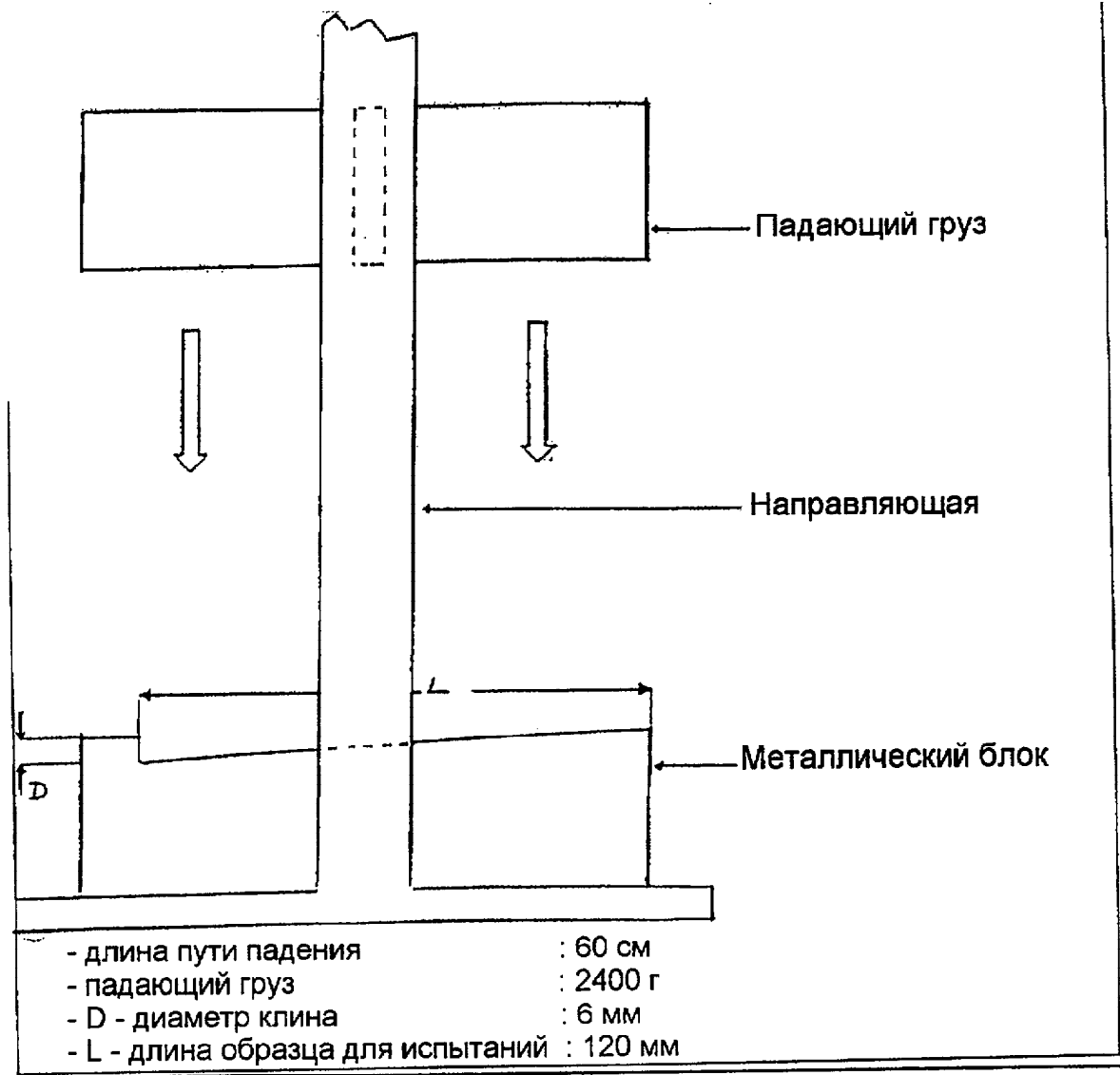
Схема аппарата для испытаний на изгиб
