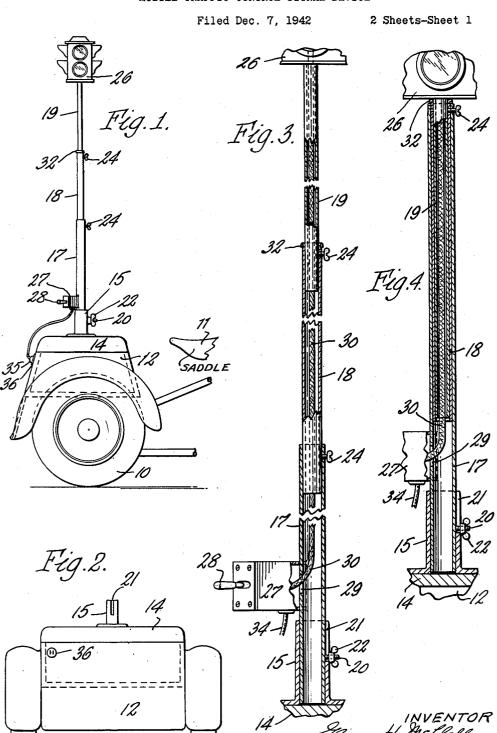
MOBILE TRAFFIC CONTROL SIGNAL DEVICE
