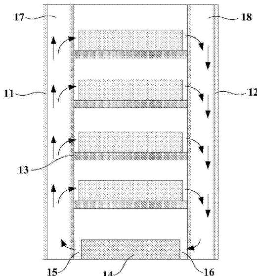
1. 一种机柜，其特征在于，包括具有前门(11)和后门(12)的封闭的柜体，位于所述柜体内用于承载电子设备的承载架(13)以及空调(14)，其中，所述承载架(13)面向所述前门(11)一面设置有用于封堵所述电子设备与所述柜体之间间隙的封堵板，所述前门(11)与所述承载架(13)形成第一通道(17)，所述后门(12)与所述承载架(13)形成第二通道(18)，所述空调(14)的送风口(15)与所述第一通道(17)相通，所述空调(14)的回风口(16)与所述第二通道(18)相通；还包括位于所述前门(11)下部的新风进风风扇(20)、具有用于过滤柜体外新风的过滤网、位于所述柜体顶板并与所述第二通道(18)位置相对的出风风扇(21)。
