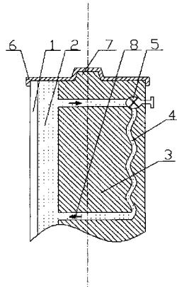
1. 一种能生热保暖防火的外墙体型材,其特征在于:包括空腹透光的保温层,加热流体介质的集热层,能保温又隔热的蓄能层,散热管,开关阀,一体构成,周边由密封胶或边框支架将其粘合、固定在一起,型材边缘上具有卯或榫联接结构。
