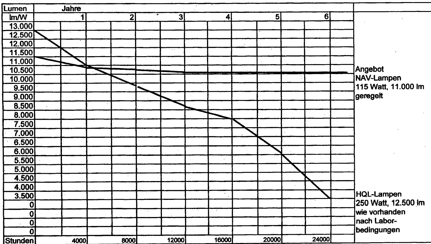
Vergleichsdiagramm des Lichtabfalls von 2 HQL-Lampen 125 Watt und 1 NAV-Lampe 115 Watt
