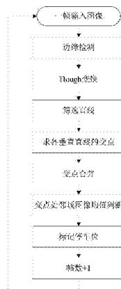
1. 一种基于视觉的 360 度泊车辅助智能引导系统, 其特征在于, 在 360 度全景泊车系统的基础上, 利用图像处理算法, 在俯视图中检测停车位, 将检测出的车位信息标注在显示屏上, 给驾驶员车位信息的提示, 并且根据检测出的车位和当前车辆的相对位置关系, 计算出车辆最优停车路线, 并将最优停车路线标注在显示屏上, 给驾驶员提供停车引导信息。
