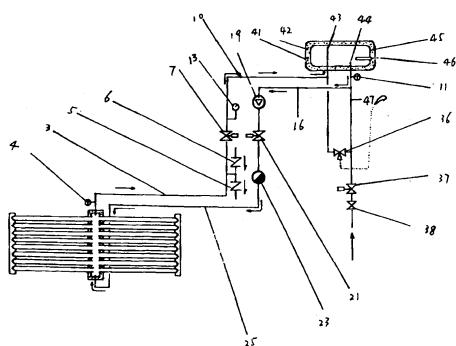
1 一种具有压力阻断装置的分体式真空管太阳能热水系统，包括集热器(40)和承压贮热水箱(31)，其特征在于：压力阻断装置(1)设置在集热器(40)和承压贮热水箱(31)之间，内置有泄压阀(5)、补压阀(6)、常闭电磁阀(7, 21)、温差监控器(15)和循环泵(19)，还具有集热器上部水温探头(4)和贮热水箱下部测温探头(11)，温度探头(4)和(11)分别通过信号线(14)与温差监控器(15)相连，循环冷水管(25)的一端与太阳能集热器(40)的真空管集热连箱(26)的冷水进口相连，另一端与压力阻断装置(1)相连，循环热水管(3)的一端与真空管集热连箱(26)的出水口相连，另一端与常闭电磁阀(7)相连，循环热水管(10)的一端与承压贮热水箱(31)相连，另一端与常闭电磁阀(7)相连，管路(47)的一端与承压贮热水箱(31)相连，另一端通过常开电磁阀(37)、自来水截止阀(38)与自来水进水管路相连，循环冷水管(16)的一端与管路(47)相连，另一端与循环泵(19)相连，泄压阀(5)、补压阀(6)分别与循环热水管(3)相连。
