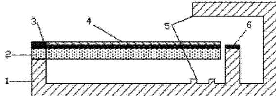
1. 一种基于光学读出的微机电电流传感装置,包括基底(1)、悬臂梁(2)、输入光波导端(3)、输出光波导端(6)和磁感应材料(4),其特征在于:基底(1)上设有悬臂梁(2),悬臂梁(2)一端固定连接,另一端为自由端,悬臂梁(2)上依次设有输入光波导端(3)和磁感应材料(4),基底(1)上输入光波导端(3)对应位置设有输出光波导端(6)。
