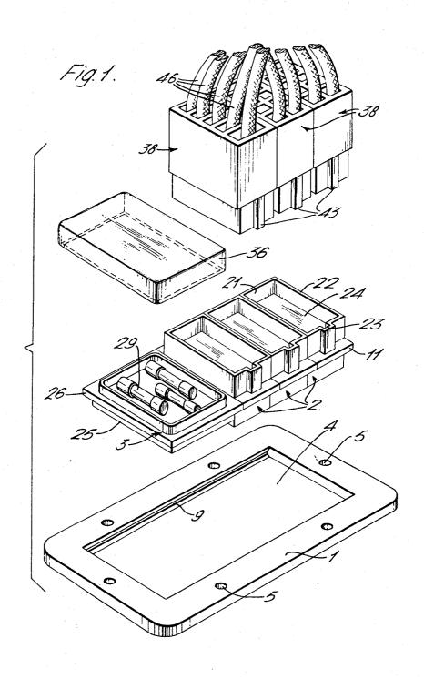
ELECTRICAL CONNECTOR HOUSING ASSEMBLY
