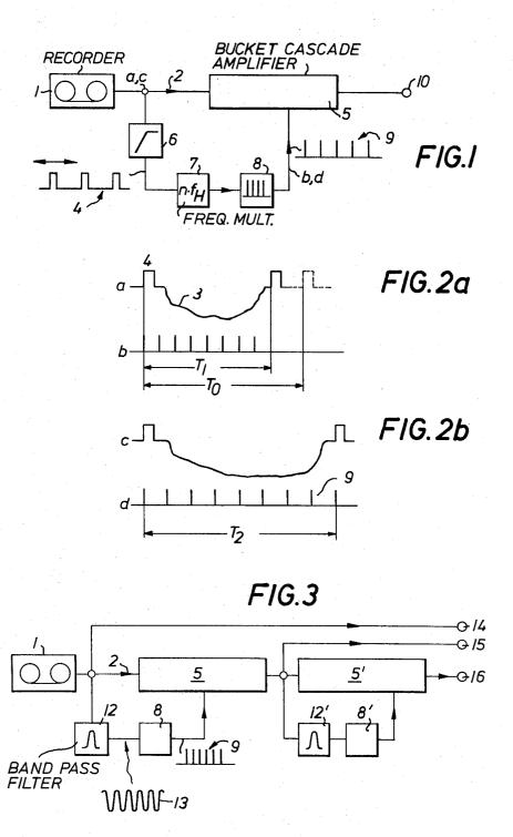
TELEVISION SIGNAL CLOCKED DELAY LINE FOR DELAY BY AN INTEGER NUMBER OF HORIZONTAL SCANNING LINES DRIVEN BY A PILOT SIGNAL
