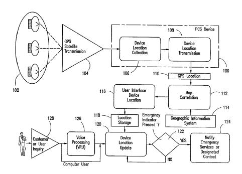
(57) L'invention concerne un système de communications hertziennes utilisant des fréquences attribuées aux services de communications personnelles (PCS) (100) ainsi que les moyens techniques du système mondial de radio-repérage (GPS) (102), pour déterminer l'emplacement exact d'un abonné sur une base périodique. Le système transmet les données d'emplacement à une base de données (118), pour mémorisation et extraction ultérieure par une application
