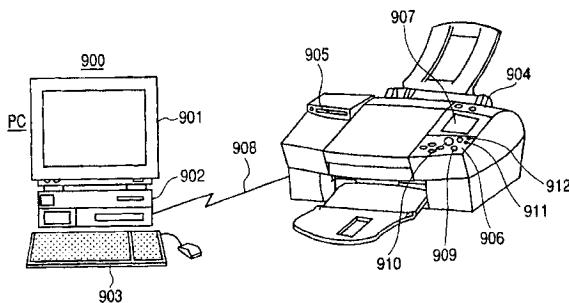
1. 一种能够与计算机进行通信并打印由所述计算机管理的图像数据的打印机的控制系统,其特征在于,包括:
