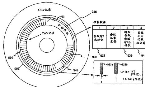
1. 一种其上记录数据的光盘，其特征在于，在所述光盘的规定区域内提供一种标识符以表示所述光盘上是否存在条形码标记，所述标识符和所述条形码标记分别位于所述光盘上的不同位置，所述条形码标记沿圆周方向设置，且所述条形码标记具有多个条，每个所述的条沿径向延伸，以及
