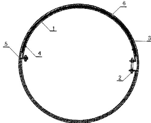
1. 一种管道裂缝内修复膨胀装置，其特征是该内修复膨胀装置由2～4片圆弧形钢圈管片(1)构成，各圆弧形钢圈管片(1)之间用膨胀螺栓(2)连接构成内钢圈，圆弧形钢圈管片(1)外侧粘合有高强度膨胀橡胶止水带(3)。
