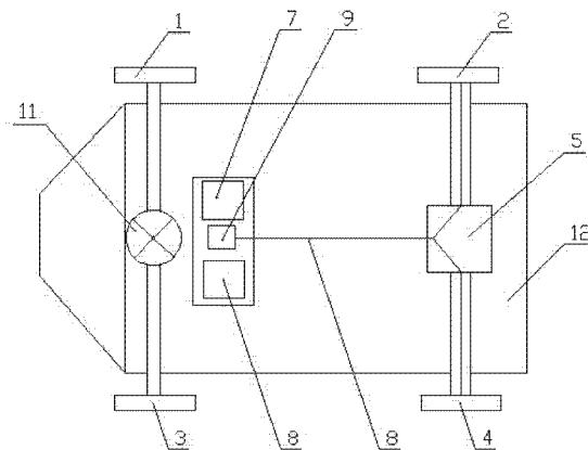
1. 一种电油混合双动力老年代步车,包括车架,在车架的前部设有方向盘和两个前轮,在车架后部设有差速后桥、传动轴和两个后轮,车架前部设有驱动装置,其特征在于:所述的驱动装置的动力源包括电动机和汽油机,电动机和汽油机之间设有双动力两用同步倒档器倒档器输出动力轴接向后传动轴和差速后桥。
